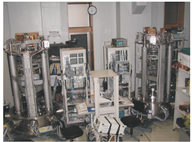
図 1.1.2: SAS を組み込んだ、3m Fabry-Perot 干渉計。干渉計の 2 枚の鏡は SAS によって防振される。
